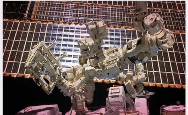
تم بناء هذا الروبوت لكي يستقر في محطة الفضاء الدولية ISS بهدف القيام بالمهام التي تتطلب حركة في الفضاء، وقد تم إطلاقه عام 2008. وهو روبوت هائل الحجم يبلغ طوله 3.5 متر ويزن 3.700 كغم، ويمكن التحكم به عن بعد.
